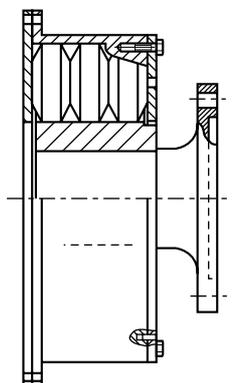
Accouplement d'arbre de liaison pour application de volant moteur à bride ou quand une plus grande distance est nécessaire entre les machines motrices et menées.
