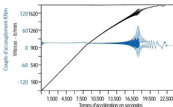
Le Tableau B montre le même système accouplé par un accouplement DCB. Un accouplement de type PM est aussi utilisé dans ces applications.
