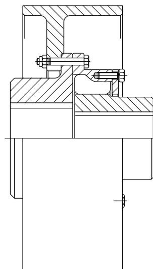
Accouplement avec tambour de frein pour grues, ventilateurs et entraînements de convoyeur (des accouplements à disques de freins sont disponibles).
