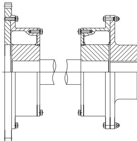
Accouplement d'arbre à cardan. Utilisé pour augmenter la distance entre les extrémités d'arbres et pour donner une capacité de désalignement supérieure.
