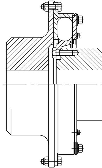
Accouplement arbre à arbre. Conçu pour les entraînements à moteur électrique et les applications à prise de force.
