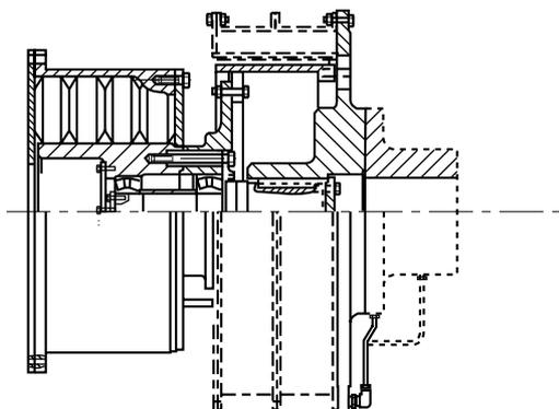
Accouplement permettant d'embrayer et de débrayer la transmission
