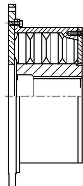
Accouplement à plaque adaptatrice pour monter l'accouplement DCB standard en fonction des exigences du client.
