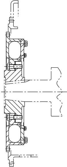
Montage de moyeu existant. Élément intérieur d'accouplement conçu pour modèle de moyeu existant.
