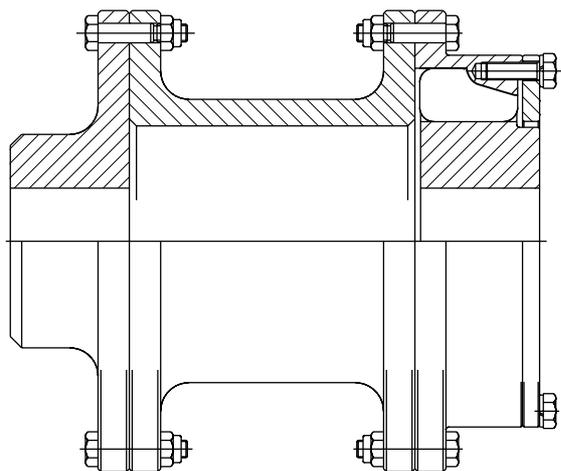
Accouplement entretoise. Utilisé pour augmenter la distance entre les extrémités d'arbre et faciliter l'accès aux machines motrices et menées.
