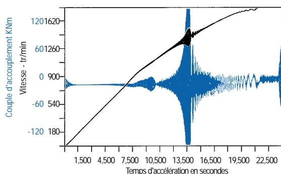
Le tableau A montre le couple de vibration subi par l'arbre moteur lorsque le système est accouplé de manière rigide (par un accouplement à denture ou membrane), au système de commande.
