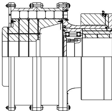
Combinaison avec un dispositif limiteur de couple pour éviter les dommages des machines motrices et menées sous effet de choc.
