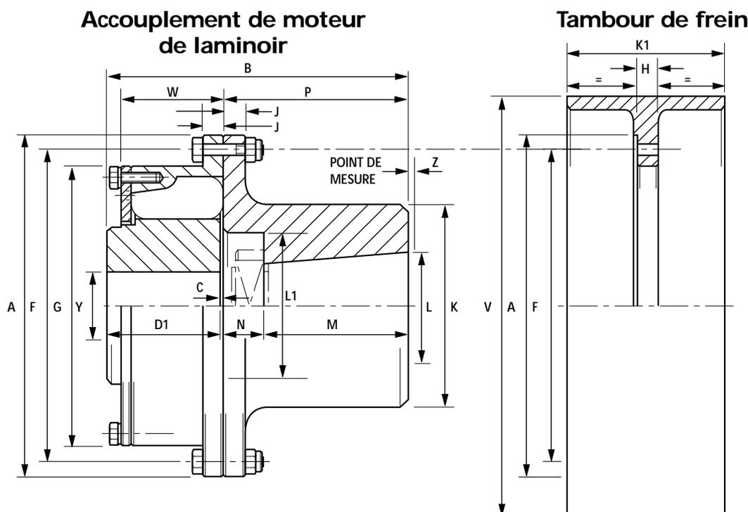
Des tambours de freins peuvent être utilisés conjointement avec toute la gamme d'accouplement PM et peuvent être boulonnés sur la bride d'entraînement ou du côté moitié flexible de l'accouplement. Le creux  $\varnothing A$  est situé sur le diamètre extérieur de l'accouplement.
