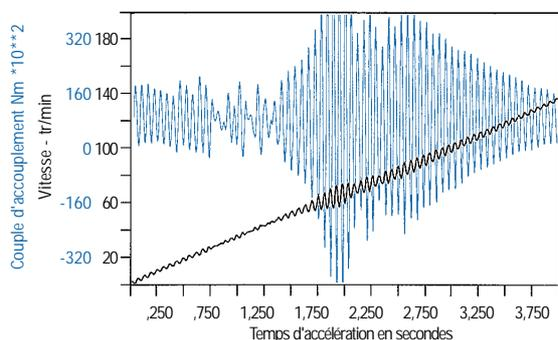
Le Tableau C montre un système moteur/ventilateur accouplé de manière rigide (accouplement à denture ou membrane) pour lequel l'arbre moteur a subi des couples destructeurs.
