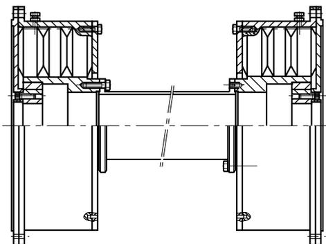
Accouplement d'arbre à cardan pour offrir une capacité de désalignement élevée, une faible rigidité axiale et angulaire, et une forte atténuation du bruit.
