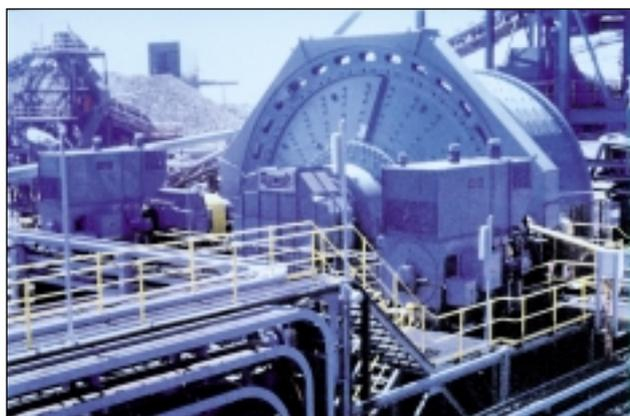
Broyeurs. Accouplements montés entre moteurs électriques, réducteur et broyeur.
