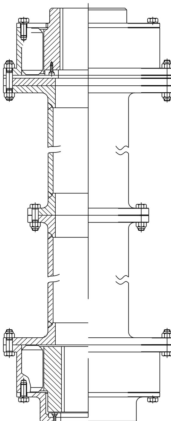
Accouplements entretoises. Utilisé pour augmenter la distance entre les extrémités d'arbre et faciliter l'accès aux machines motrices et menées.
