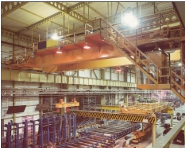
Laminoirs. Accouplements montés sur pont roulant de 35 tonnes et sur les mécanismes de commande des tables à rouleaux.
