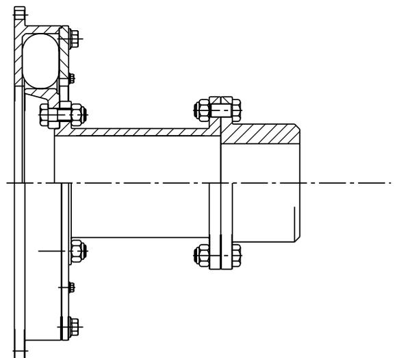
Accouplement entretoise. Utilisé pour augmenter la distance entre les extrémités d'arbre et faciliter l'accès aux machines motrices et menées.
