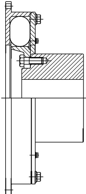
Accouplement à élément intérieur inversé pour augmenter la distance entre la face du volant moteur et l'extrémité de l'arbre.
