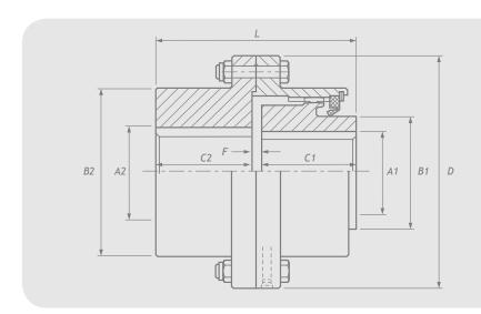
Los acoplamientos serie D de engranaje sencillo se utilizan comúnmente en parejas con un eje oscilante, para conectar equipos muy separados entre sí y admitir la desalineación por desplazamiento, angular o combinada.
