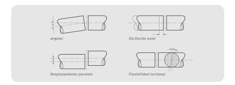
Deben usarse acoplamientos flexibles para tolerar cualquier combinación de las situaciones de desalineación descritas arriba.
